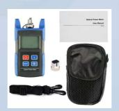
仕様 (測定範囲) -50~+26dBm (波長)800~1700nm (校正波長) 850.1300.1310.1490.1550.1625 (受光素子)InGaAs (精度)±3% (分解能)0.01dBm (電源)単4電池3本 (動作温度)-10°C~+50°C (動作時間)120Hr以上(パックライト消灯) (寸法)130×69×29mm (重量)160g
